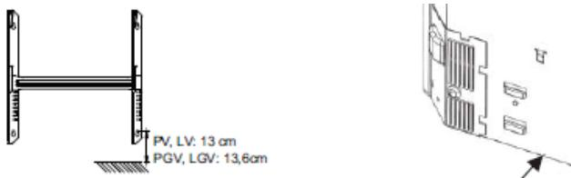
В долната част на задната плоча има две малки триъгълни релси. Поставете отоплителния уред на релсите и го бутнете към маншетите върху конзолата във вертикално положение.
